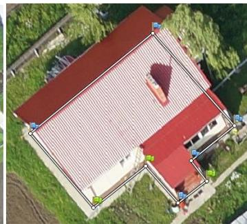
Испытания ФГБУ «Центр геодезии, картографии и пространственных данных» подтверждают точность определения координат картометрическим методом по ортофотоплану на уровне 5-9 см и фотограмметрическим методом по снимкам на уровне 3-5 см для высоты полета БЛА Геоскан 200-400 м (в ПО Agisoft PhotoScan Pro)
